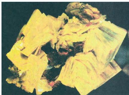
Εικόνα 23 Κίτρινοι κρύσταλλοι σύνθετου άλατος του ουρανίου (ένυδρο φωσφορικό ασβέστιο - ουράνιο).
