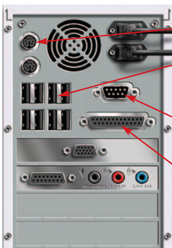
Εικόνα 2.6. Οι θύρες σύνδεσης του υπολογιστή
