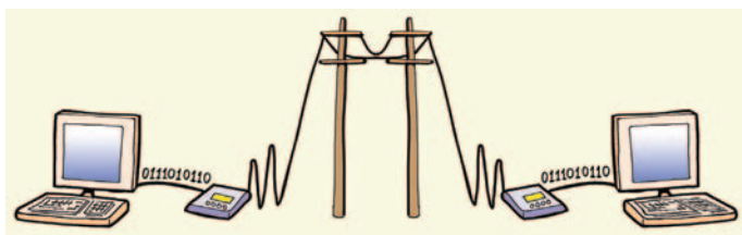
Εικόνα 4.6. Σύνδεση δύο υπολογιστών μέσω σταθερής τηλεφωνίας
